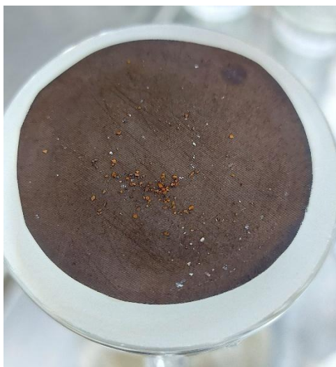
9. attēls. Paraugs izfiltrēts uz nerūsējošā tērauda filtra pēc Fentona oksidācijas reakcijas.
