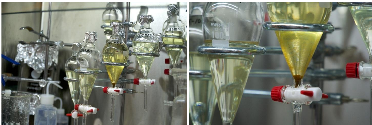
8. attēls. Paraugu blīvumseparācija neorganiskā materiāla nodalīšanai.
