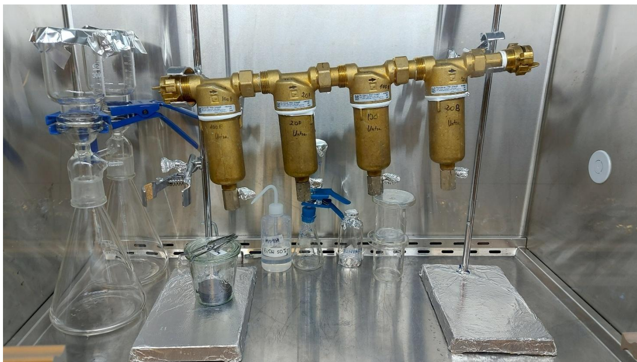
4. attēls. Filtru kaskādes konfigurācija laminārās plūsmas skapī.
