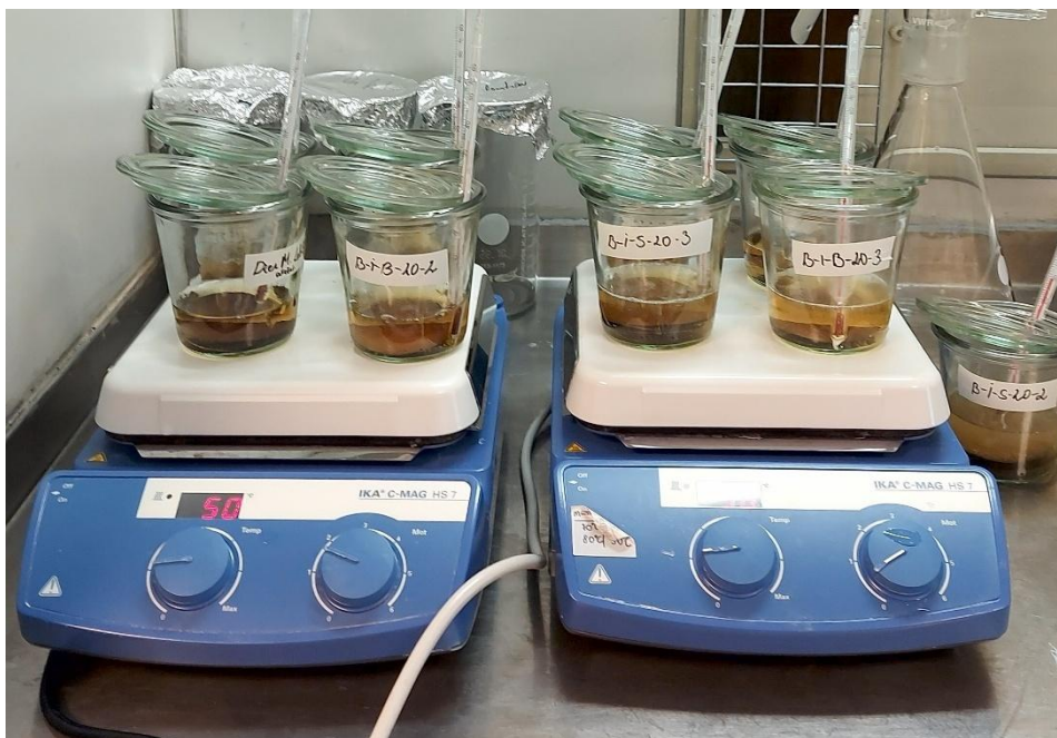
7. attēls. Fentona oksidācijas reakcija organiskā materiāla nograuššanai.
