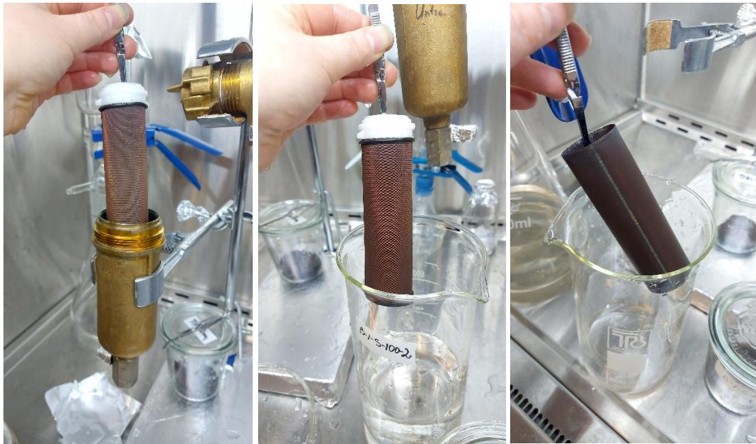
5. attēls. Parauga filtra izņemšana no filtra turētāja.
